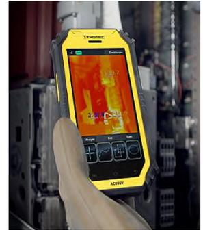
Contrariamente ai pirometri a un punto o alle termocamere a forma di pistola dotate di mini-sensore, questo tablet termografia dispone di 19.200 punti di misurazione della temperatura radiometrici, che rilevano anche le più piccole variazioni di temperatura in tempo reale.
