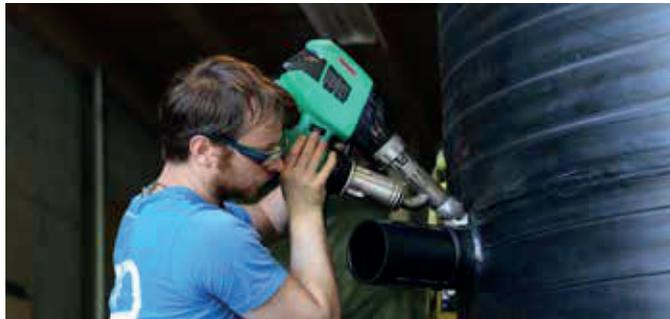
Il maneggevole estrusore WELDPLAST S2 in funzione.
