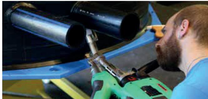
L'irraggiungibile è saldabile con i nuovi adattatori ad angolo di 45° e 90°.
