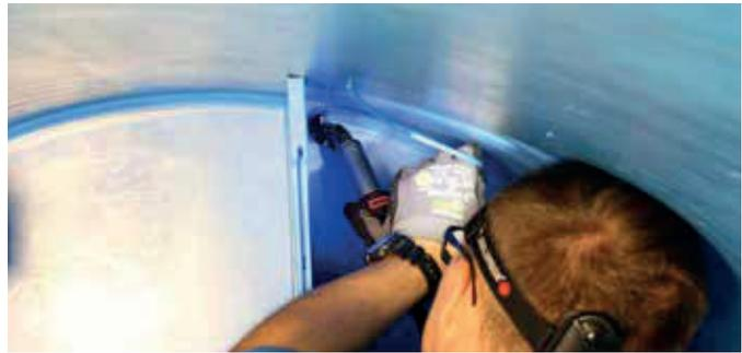
In abbinamento all'adattatore angolare, il prodotto WELDING PEN R consente di eseguire anche la saldatura di punti di difficile accesso.
