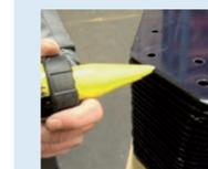
Protezione angoli con sigillante, protezione contro la corrosione
