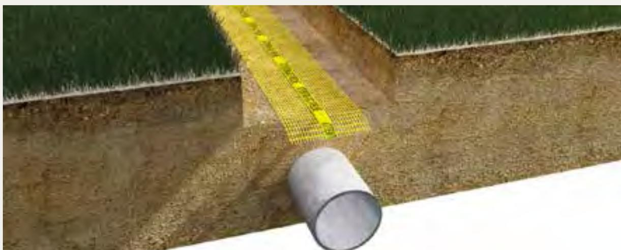
**3** - Ricoprire la condotta così segnalata in modo che la profondità complessiva di interrimento non sia inferiore a quanto stabilito per il caso specifico dalle normative vigenti.
