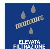
Composto da una rete drenante a maglia romboidale accoppiata su entrambi i lati a due tessuti non tessuti. La sua struttura lo rende prevalentemente adatto all'uso in verticale, come protezione della guaina impermeabilizzante e come strato di separazione/drenaggio.
