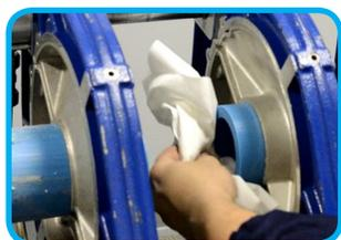
Prima di posizionare i componenti da saldare, si deve effettuare la pulizia della zona interessata alla saldatura.
