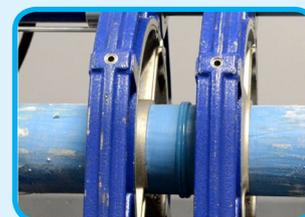
Rimosso il termoelemento porre a contatto i lembi incrementando la pressione in modo progressivo.
