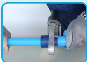
Al raggiungimento della temperatura di lavoro di 260°C inserire contemporaneamente con una leggera pressione il tubo ed il raccordo nelle apposite matrici.
