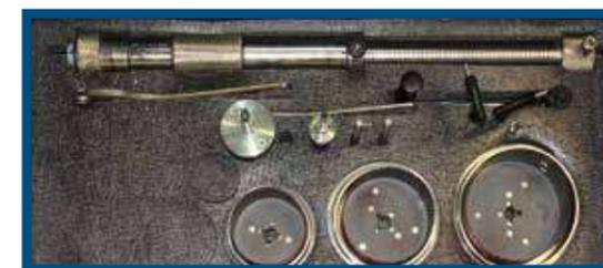
La cassetta contenente la macchina foratubi comprende i seguenti accessori necessari al suo montaggio/funzionamento.
