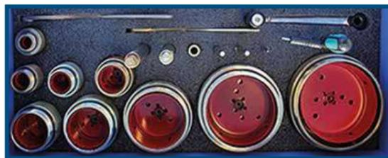
La cassetta contenente la macchina foratubi comprende i seguenti accessori necessari al suo montaggio/funzionamento.
