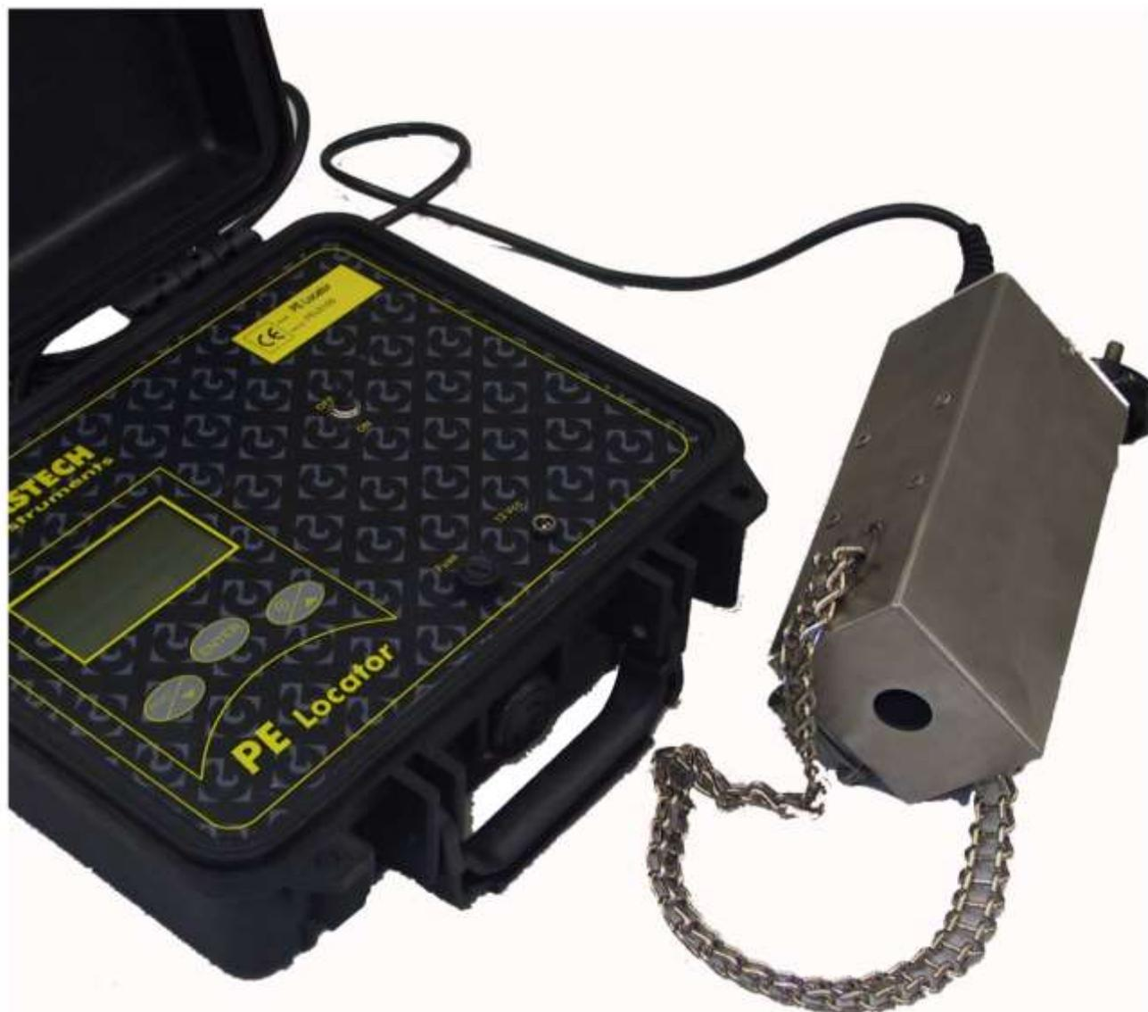
**GLOC PE LOCATOR** è lo strumento progettato per permettere la localizzazione rapida e precisa delle tubazioni in pressione di reti idriche ed antincendio in materiale plastico. Il generatore meccanico di impulsi è agilmente e velocemente applicabile anche a tubazioni di piccole dimensione come gli allacci di utenza tramite la morsa a catena regolabile.
