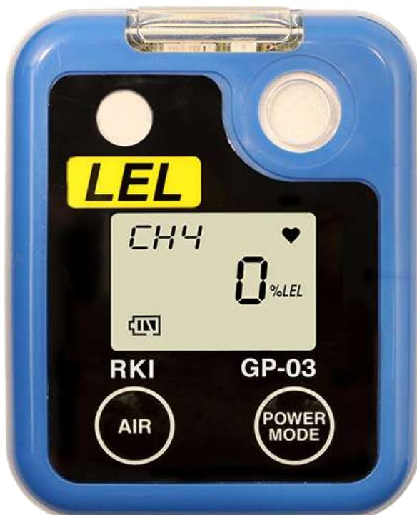
**GASTECH RKI GP-03** è un esplosimetro palmare per la rilevazione di gas esplosivi in cantieri o spazi confinati. Lo strumento ideato per le squadre di pronto intervento, ha una elevata sensibilità, affidabile e leggero. Uno strumento adatto a qualsiasi intervento di manutenzione e ricerca delle perdite di gas in tubazioni poste fuori terra.
