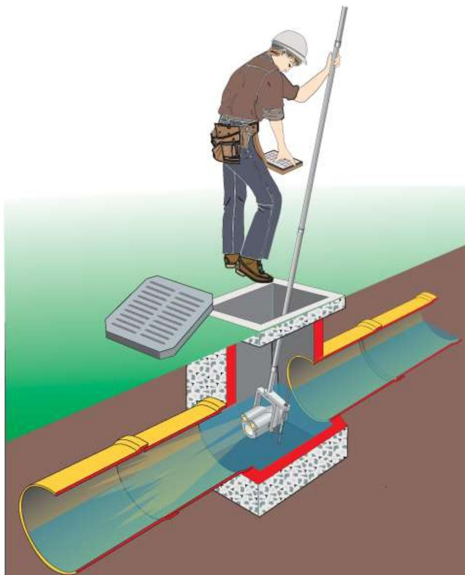
Sistema per la Video Ispezione di Canali Aperti quali le Fognature, abbinato ad un sistema di visione a registrazione offre un utile supporto a coloro che operano nell'ambito di tubazioni fognarie e canali di scarico
