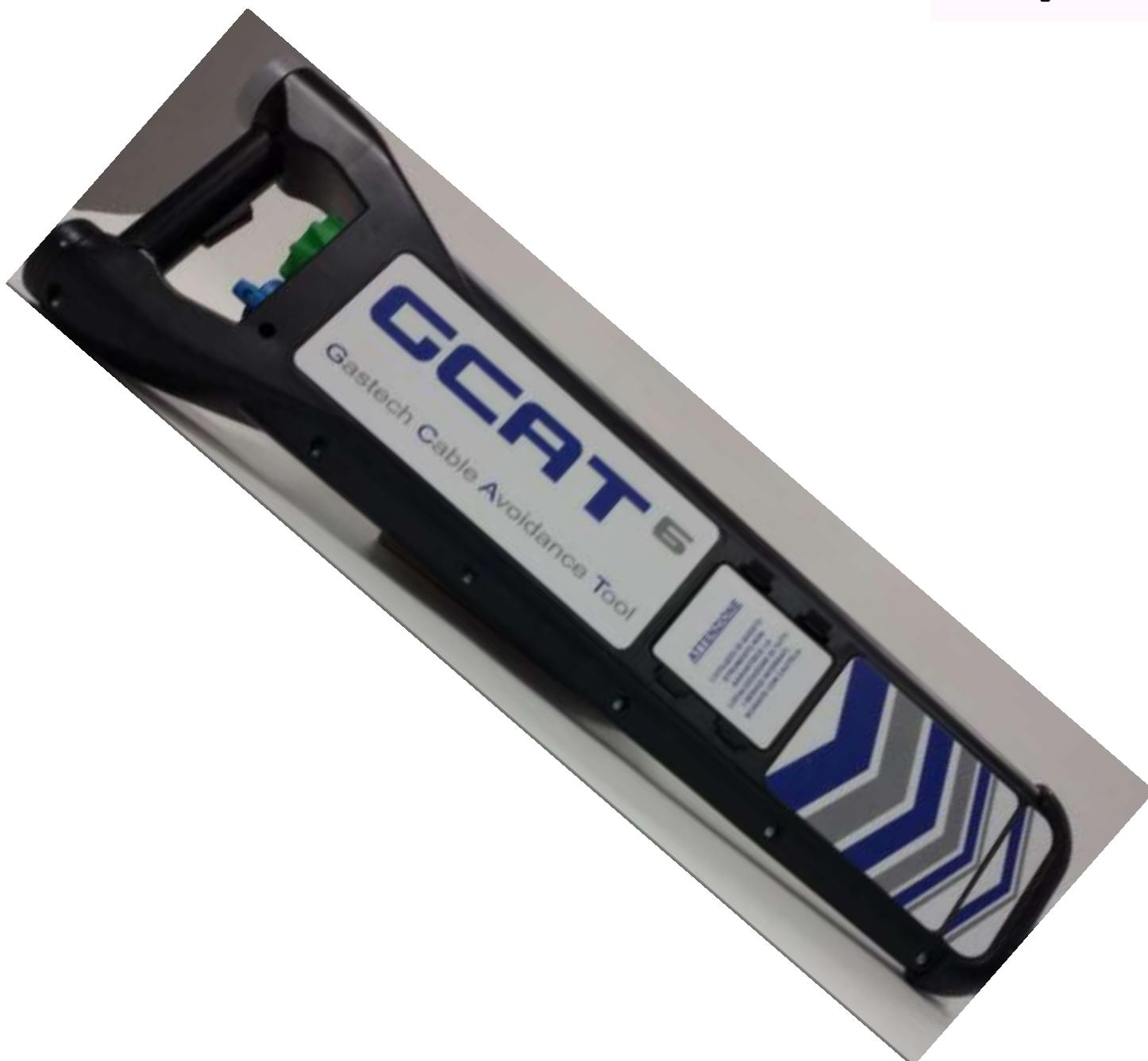
Cerca Tubi / Cerca Servizi digitale per la localizzazione dei servizi interrati prima dello scavo. E' possibile localizzare utilizzando unicamente la Ricevente: condutture metalliche , cavi elettrici "in tensione" e cavi telefonici "in esercizio; oppure è possibile, abbinato alla trasmittente, tracciare una condotta e rilevarne il percorso
