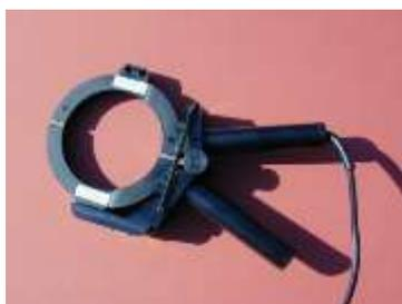
**PINZA TOROIDALE 33 KHz**
