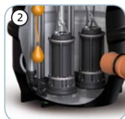
2 Installazione dell'elettropompa con piede d'accoppiamento fissato al fondo tramite viti con guarnizione a tenuta ermetica e barre di rinforzo in acciaio.
