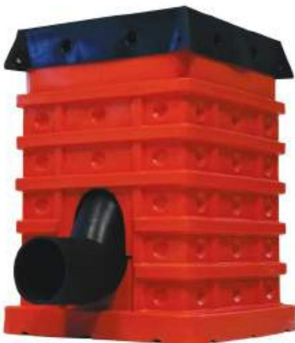
sostituire le caditoie stradali di concezione classica; pertanto la sua funzione specifica è la raccolta delle acque meteoriche del piano stradale e dei residui solidi dilavati. Per assolvere al suo compito il pozzetto deve essere collocato interrato, pronto per accogliere sul suo coronamento la griglia in ghisa sferoidale posta allineata con il piano stradale.
