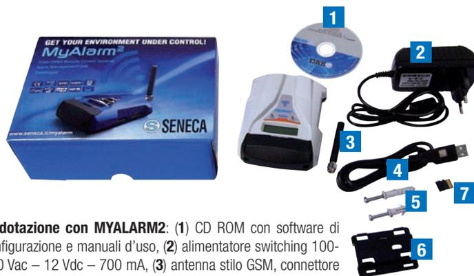
In dotazione con MYALARM2: (1) CD ROM con software di configurazione e manuali d'uso, (2) alimentatore switching 100-240 Vac – 12 Vdc – 700 mA, (3) antenna stilo GSM, connettore SMA, (4) cavo USB-mini USB 2.0 (5)-(6) viti e staffa di fissaggio, (7) micro SD con adattatore (solo per MY2S e MY2G).
