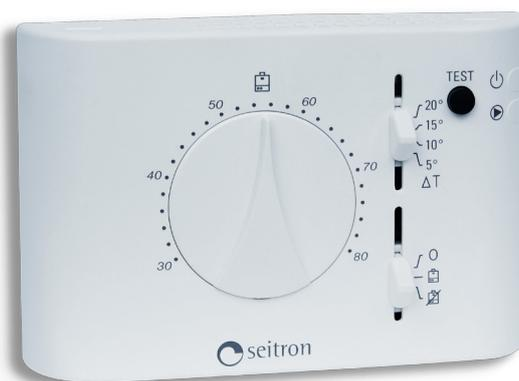
L' interfaccia con l'utente consiste in una manopola per l'impostazione della temperatura di intervento della sorgente integrativa, di un selettore per impostare il Delta T desiderato fra collettore ed accumulo, e di un selettore OFF / acceso con integrazione / acceso senza integrazione. Un tasto TEST per verificare il buon funzionamento della pompa e due LED completano il regolatore.
