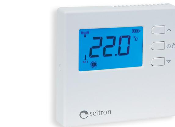
TRD02B è soprattutto molto versatile: 3 diversi regimi di funzionamento (Comfort, Ridotto, Antigelo), la scelta fra uscite di regolazione on-off e proporzionali (PWM), la possibilità di impostare isteresi, banda proporzionale, tempo integrale e di ciclo, ne fanno un regolatore completo.
