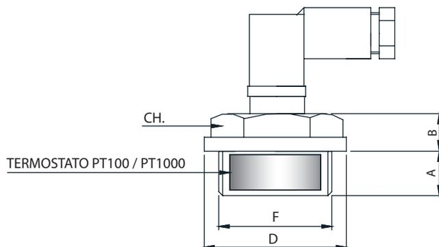
La sonda di temperatura occupa lo spazio previsto per ogni comune tappo di scarico per serbatoi, centraline, coppe dell'olio, etc.
