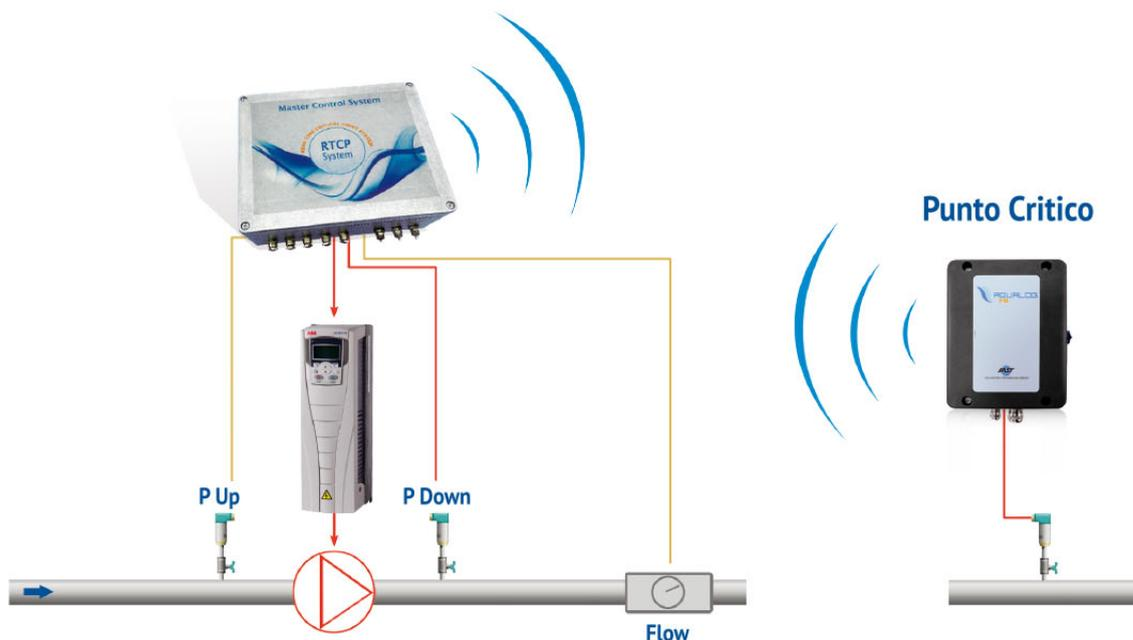
Il Sistema RTCP non necessita di software o data servers remoti: il ciclo di regolazione è controllato localmente dal Master Control System. Il sistema è gestibile facilmente con un semplice browser sui più moderni e comuni dispositivi collegati alla rete globale (PC, Tablet, Smartphone).
