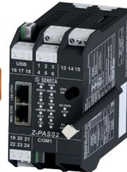
Z-PASS2-S è un controllore ad elevate prestazioni con 6 I/O digitali integrati in grado di coniugare le funzionalità PLC con quelle di routing e accesso remoto. È infatti basato su softPLC Straton con funzionalità integrate web server, VPN e modem / router 3G+ worldwide penta-band o 4G LTE con GPS/Glonass. Z-PASS2-S può supportare connessioni Point-To-Point-Teleassistenza o Single LAN Telecontrollo.
