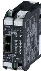
Z-TWS4 è un sistema di controllo avanzato con 4 I/O integrati, 1 porta CAN, 4 porte seriali, 2 porte USB, doppia porta Ethernet. Ideato per automazioni di impianto (Straton - Soft PLC IEC 61131-3) e applicazioni di Energy Management (grazie ai protocolli IEC 60870-5-101, IEC 60870-5-104, IEC 61850), Z-TWS4 è anche una CPU Linux-based concepita per applicazioni di acquisizione dati e controllo.
