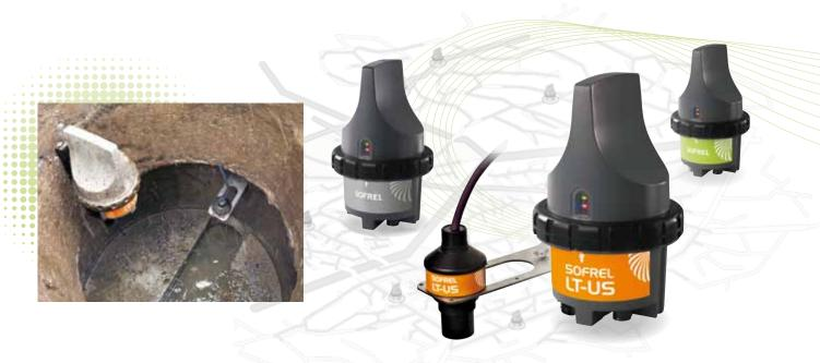
I data logger SOFREL LT e LT-US sono stati progettati per la sorveglianza delle reti di acque reflue e pluviali (collettori, scolmatori di pioggia...). Perfettamente stagni (IP 68 rinforzato), alimentati tramite batteria con autonomia massima di I0 anni, sono dotati di modem GSM/GPRS e di un'antenna estremamente efficiente progettata per l'uso in camere di conteggio interrate.
