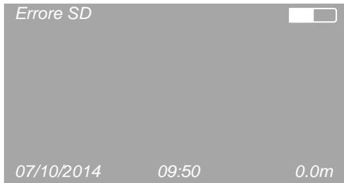
*Prima di procedere con la registrazione di audio-video e salvataggio foto, verificare che la SD card sia presente e correttamente inserita, se non dovesse essere così in alto a sinistra apparirà un allarme “Errore SD”*
