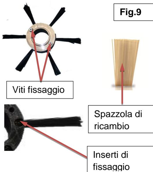
*Svitare le viti di fissaggio indicate in fig.9, sfilare dagli inserti di fissaggio le spazzole usurate inserire le nuove e richiudere il centratore.*
