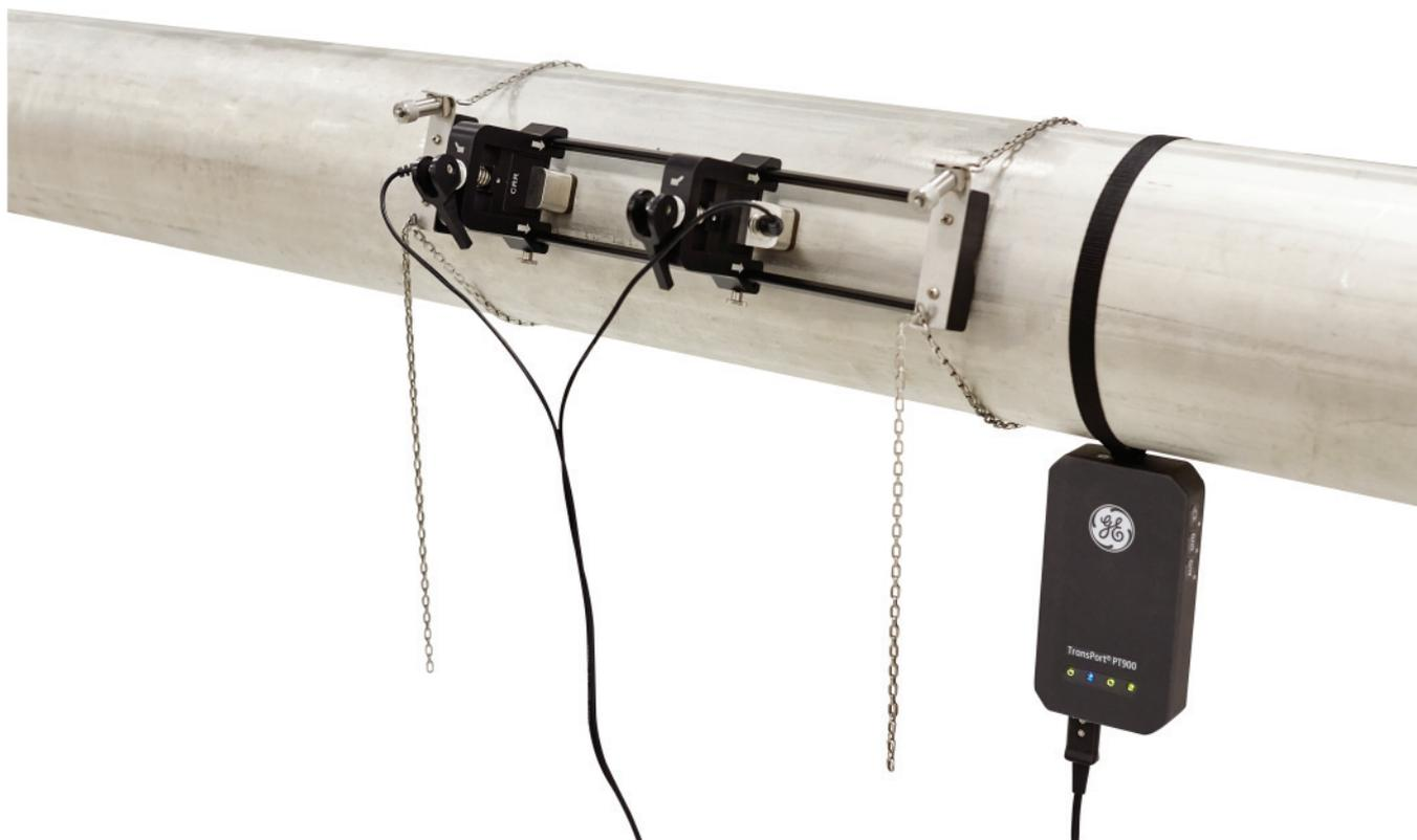
*Staffa di supporto, trasduttori e trasmettitore montati sul tubo*
