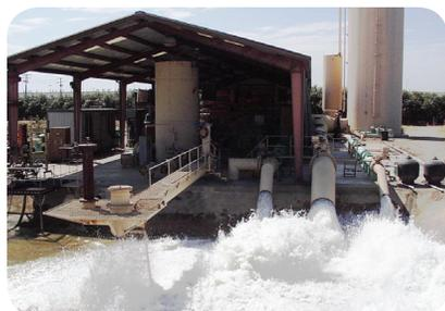
Il nostro stabilimento di test di grandi volumi si trova a Porterville, in California. Si tratta di uno dei centri di test volumetrici più grande al mondo di proprietà di un produttore di misuratori, che offre test di precisione e calibrazione di flussometri da 7,62 a 182,88 cm di diametro, con portate fino a 227.124,71 litri al minuto.
