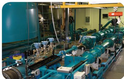
Il nostro stabilimento di Hemet, in California, vanta un laboratorio di test della calibrazione efficiente che consente la produzione della strumentazione di flusso più accurata e precisa. L'impianto di test si avvale di tre sistemi gravimetrici e due sistemi volumetrici che effettuano test di precisione e calibrazione dei flussometri da 1,27 a 50,8 cm di diametro, con portate fino a 15.141,65 litri al minuto.
