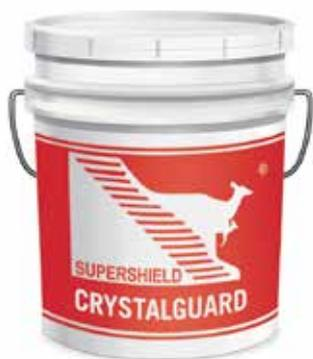
**Supershield Crystalguard è un prodotto cristallizzante monocomponente a base cementizia, che va miscelato con acqua e applicato come rivestimento in forma di boiacca al lato positivo o negativo delle superfici in calcestruzzo. Può essere applicato sia in unica passata, sia in due passate successive.**
