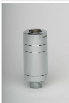
I Super Catalyzer serie 3000 BABY GAS sono prodotti nati per trattare il gas per impianti domestici fino a 30.000 K/cal. Devono essere installati all'ingresso del gas sulle caldaiette murali o a basamento, ed eventualmente sull'attacco di lance sempre a gas con potenza singola non superiore a 30.000 K/cal. Dimensioni: mm Ø 32 x 81 attacco 1/2" M/F., sono costruiti in ottone cromato. I Super Catalyzer non hanno verso di montaggio.
