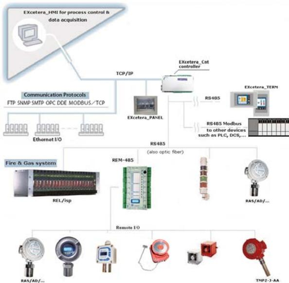
La tecnologia bus digitale con protocollo standard, ModBUS RTU, FTP o Ethernet e la programmazione tramite Web assicura un'affidabilità assoluta e permette configurazioni di monitoraggio Stand-alone o comunicazione con DCS, BMS o PC remoti.
