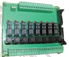
**RS-485** Ripetitore indirizzabile per allarme sonoro e visivo secondo il protocollo Modbus
