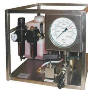
Centralina idraulica ad alim. pneumatica per tensionatori AIR-T, pressione max 1500 bar, manometro, robusta incastellatura di protezione, con gruppo filtro lubrificatore e regolatore pressione, può alimentare fino a 8 tensionatori simultaneamente, peso 26kg
