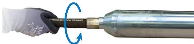
Qualsiasi operazione di inversione o cambio marcia avviene dalla tubazione aria, girando di 1/4 a sinistra. Il passaggio dall'1 marcia o dalla 2 nella retromarcia lo si esegue durante la fase di lavorazione.
