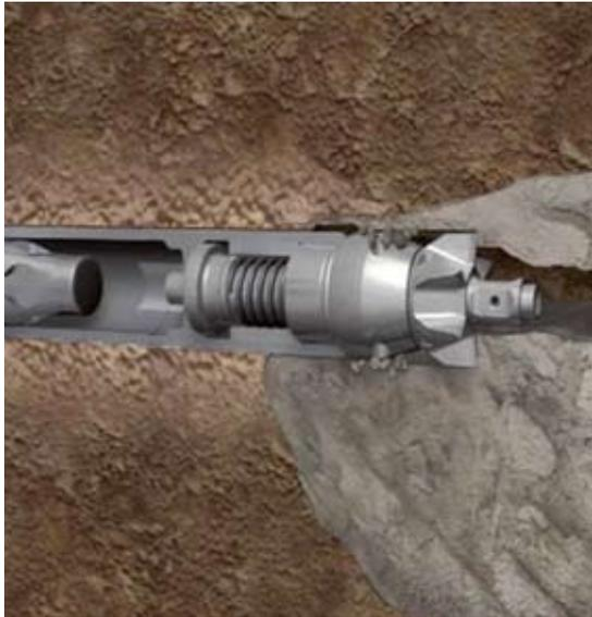
Vantaggio del sistema a due tempi in fase di attacco di un sasso.
