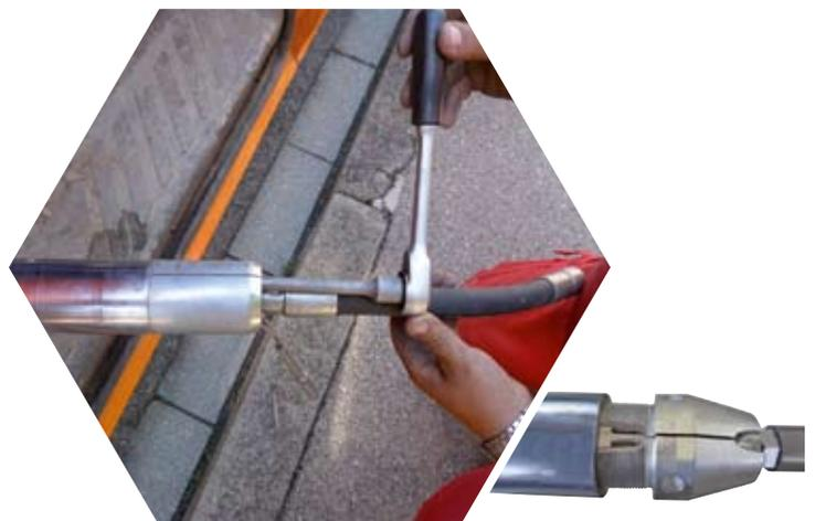
Sostituzione del cono di retromarcia con bicchiere di tiro con elemento ad espansione (nessun collante)
