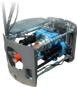
**GRUNDOBORE** – Presso trivella con guida pilota, per esempio la posa di condotte a gravità Modelli 200S e 400
