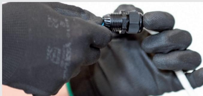
1. IL PRESSACAVI, fornito in dotazione, va applicato sul cavo di alimentazione.
