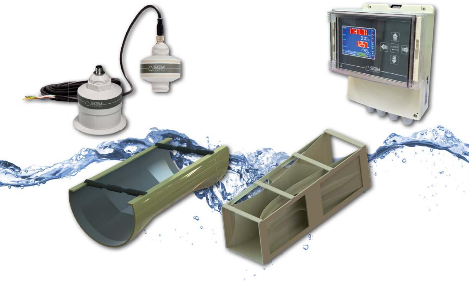
La misura di portata in canali aperti con il metodo del risalto idraulico si realizza con l'utilizzo, all'interno del canale o tubo parzialmente pieno, di un modellatore idraulico (BS - canali venturi / PB - palmer bowlus) , una sonda per la misurazione del livello (in questo caso ad ultrasuoni (PTU50; PTU51, senza contatto con il liquido stesso) e una centralina associata (VLW90M) per la conversione del livello nella corrispondente portata istantanea.
