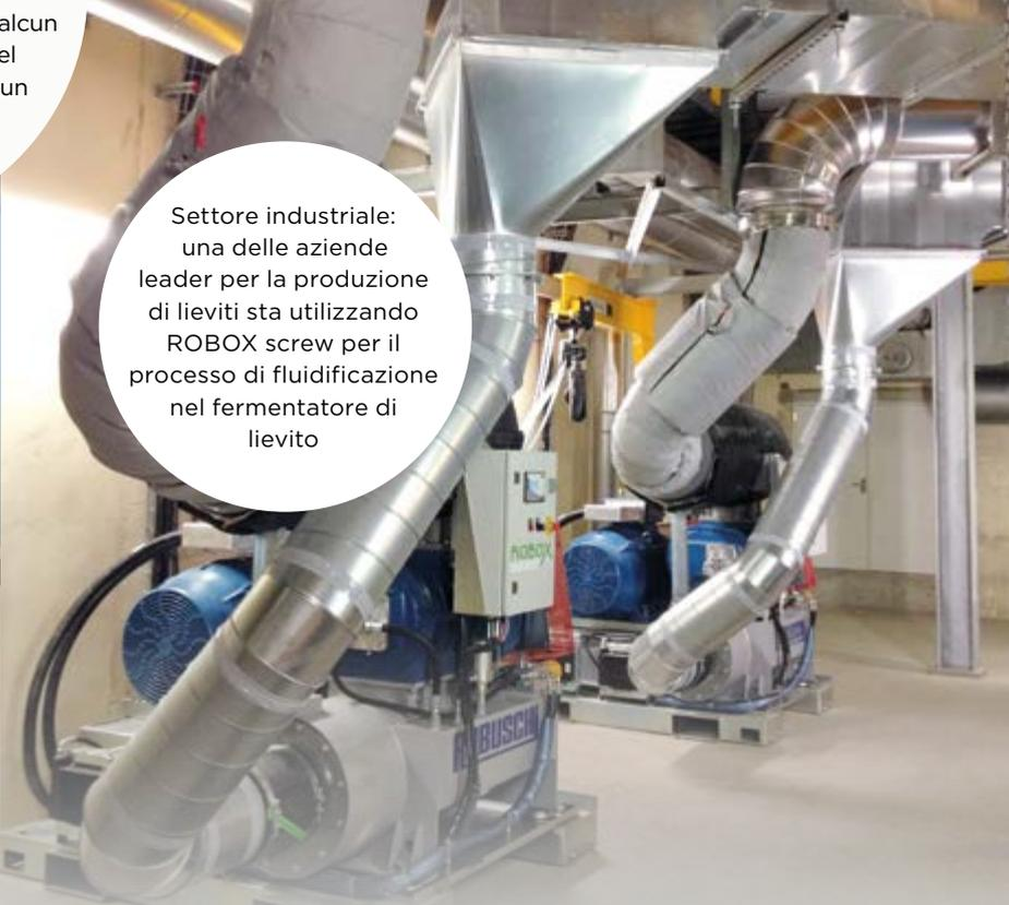
Settore industriale: una delle aziende leader per la produzione di lieviti sta utilizzando ROBOX screw per il processo di fluidificazione nel fermentatore di lievito.
