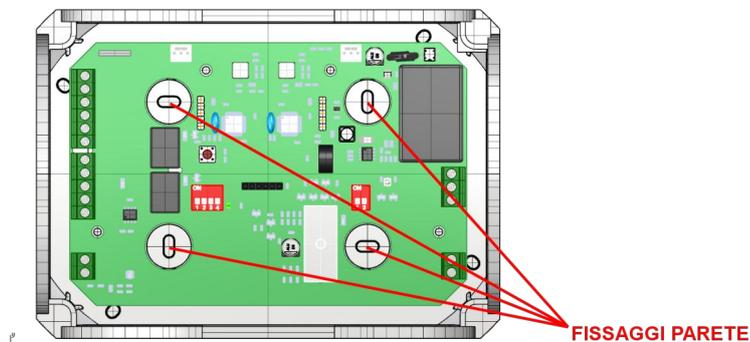
In un dispositivo di rivelazione delle vibrazioni il fissaggio a parete deve essere eseguito prestando molta attenzione.
