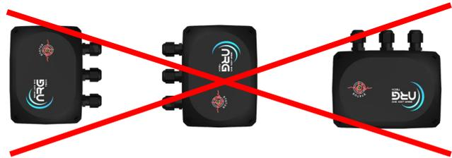
Il sensore sismico contiene un inclinometro che interviene quando l'inclinazione del dispositivo è superiore a 10°. Installare il dispositivo servendosi di una bolla per evitare il suo intervento.
