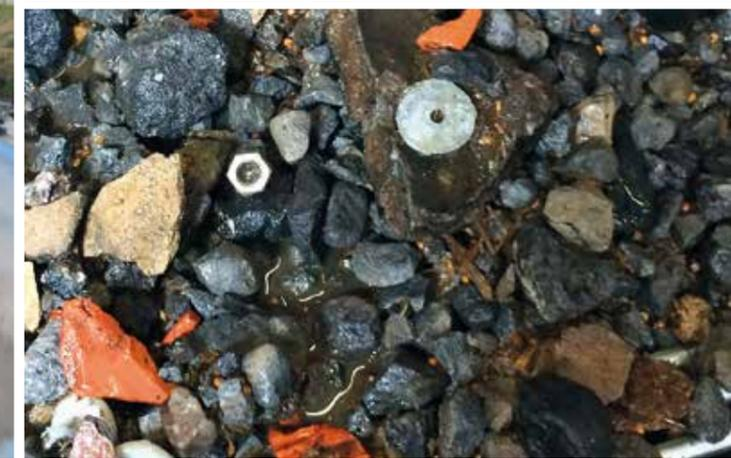
Mentre il fluido scorre costantemente attraverso il RotaCut, i corpi pesanti come pietre o parti metalliche vengono separati per gravità, mentre fibre e materiale solido vengono uniformemente tritati con contemporanea omogeneizzazione del fluido.
