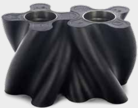
Il modello HiFloplus riduce le vibrazioni e il rumore creato dalle pompe a lobi rotativi Vogelsang, specie a pressioni elevate.
