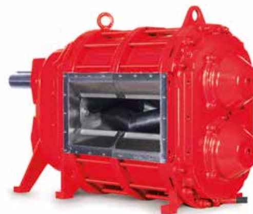
Vogelsang VX-QD – pompa QuickService con terzo cuscinetto flangiato
